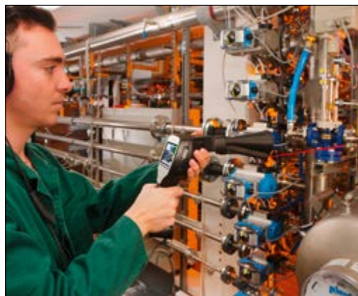
Der schalldichte Kopfhörer ermöglicht die Lecksuche auch bei extrem lauter Umgebung. Die Umgebungsgeräusche werden ausgeblendet, die Leckage (nicht hörbarer Ultraschall) wird in ein hörbares Signal gewandelt. Der Laser ermöglicht eine genaue Ortung.
