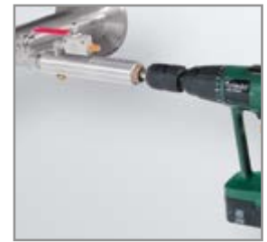
Anbohren unter Druck mit der CS Bohrvorrichtung
