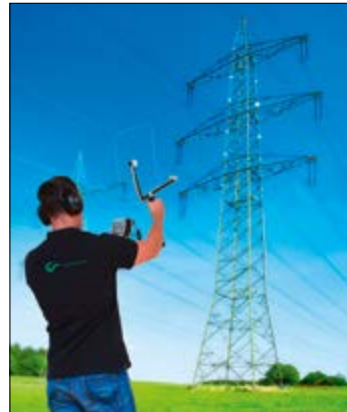
Überprüfen von Hochspannungs-Freileitungen auf Koronantladung
