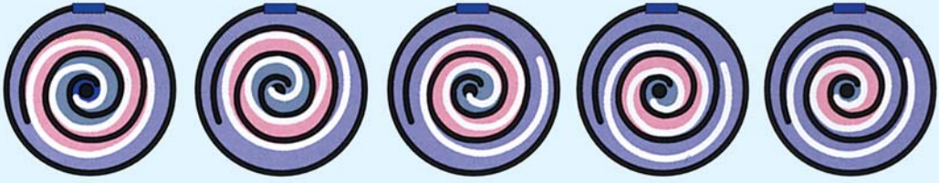
Arbeitsprinzip eines Scrollkompressors
